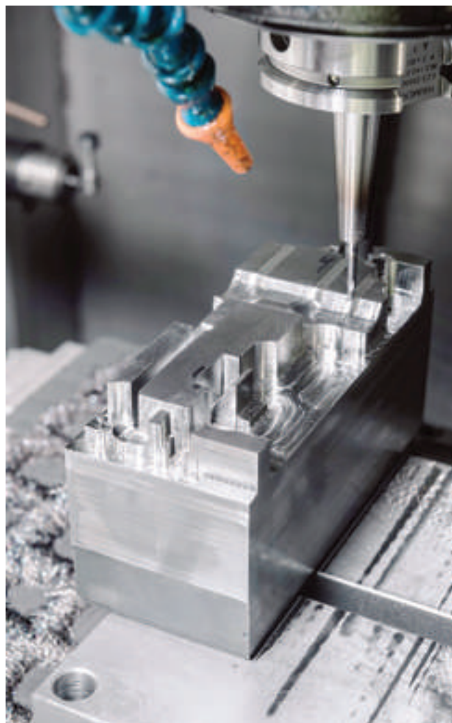
Particolare di un tassello impronta stampo in acciaio lavorato da una fresatrice alla Nts di Lallio
